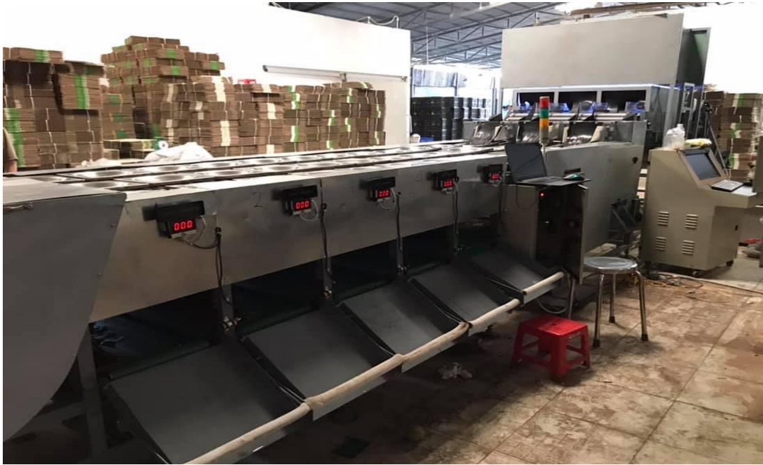
Hình 4.47. Hệ thống phân loại xoài sử dụng công nghệ xử lý ảnh kết hợp AI
